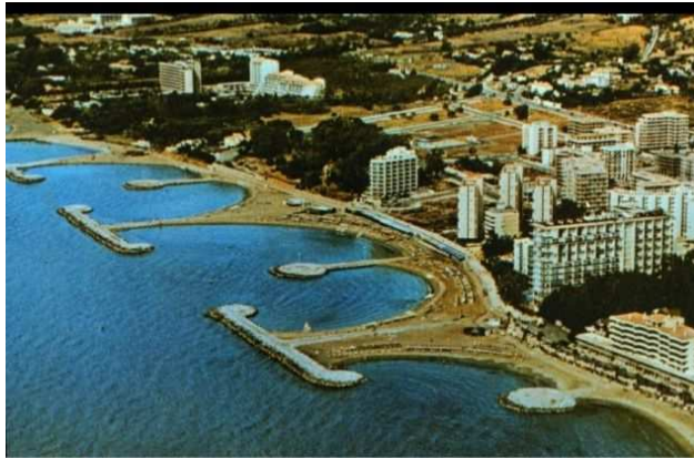
Slika 6.25: Primjer izvedbe različitih oblika razbijača valova i mogućih različitih namjena novih površina obale (Izvor: http://www.slideshare.net/ShirsakMondal/marine-coastal-structures-62848411 )
