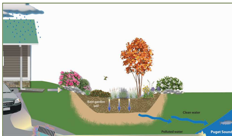
Slika 6.27: Shematski prikaz postupaka regulacije površinskih voda u naselju
