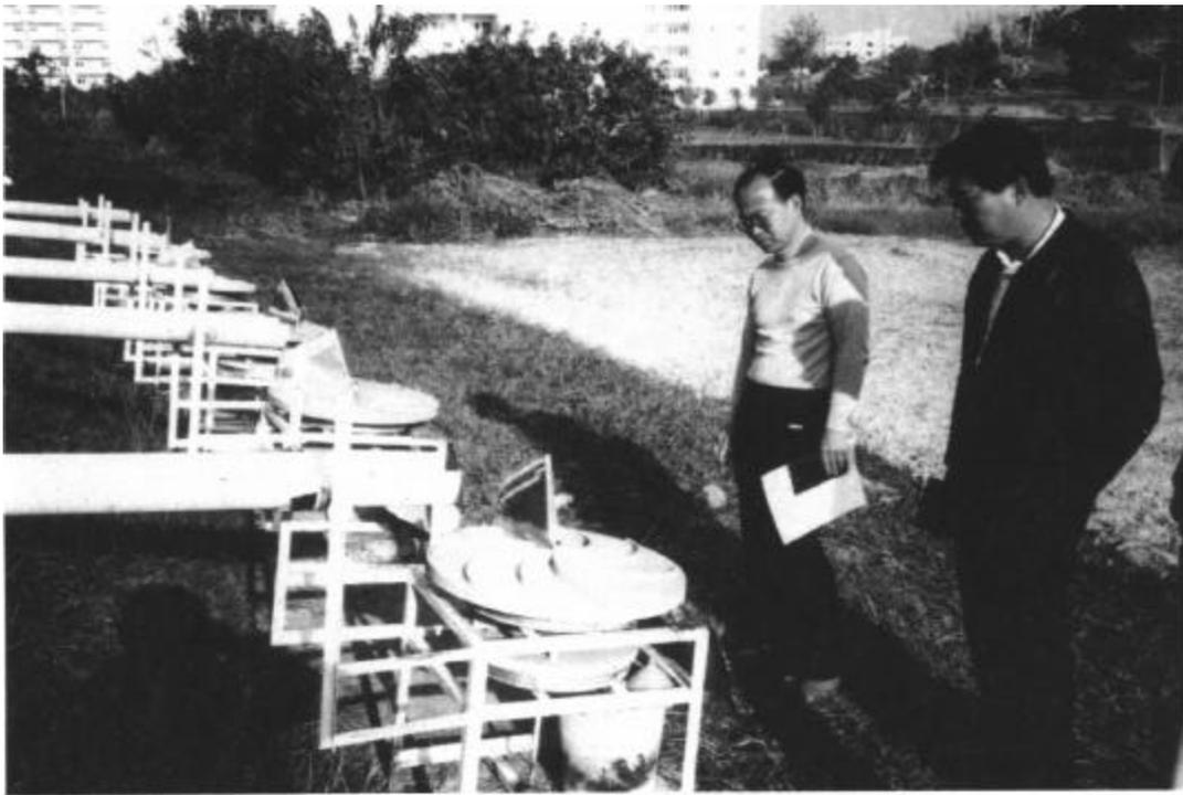
Figure II-3: Echantillonneur à roue de Coshocton
